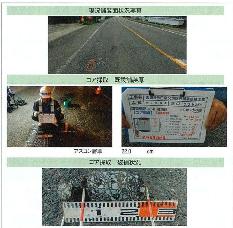
小川町地区で実施した舗装の事前調査の結果。下部のアスコン層に劣化が見られた(資料:日章工業)
