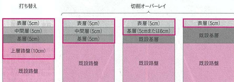
カッコ内は厚さ。赤枠内が補修範囲。表層は密粒度ギャップAs改質II型、中間層と基層は粗粒アスコン改質II型、上層路盤は粒調Fe処理材
